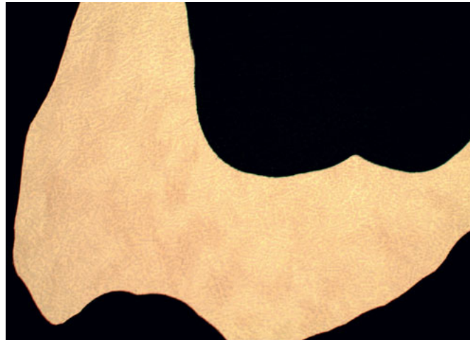
Abb. 6 Das Schlibbild einer Molarenkrone, gefräst aus einem Oberkiefer-5-Blank, zeigt ein homogenes Gefüge.
