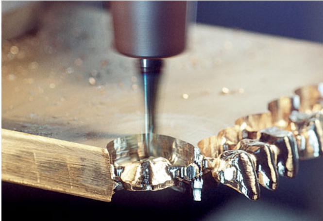
Abb. 1 CAD/CAM-Bearbeitung hochgoldhaltiger Legierungen.
