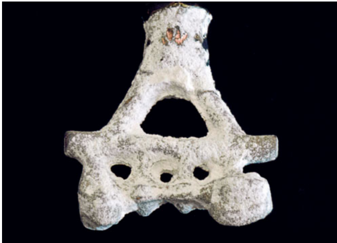
Abb. 5 Bei CAD/CAM muss die Legierung nicht erneut aufgeschmolzen werden. Beim Guss dagegen kommt die heiße, flüssige Schmelze in Kontakt mit der Einbettmasse, reagiert und oxidiert.
