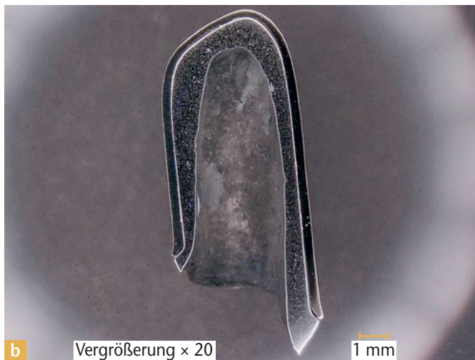
Abb. 7a bis c: Hauchdünnes, sehr gleichmäßig gefrästes Sekundärteil aus Orplid H auf einem Primärteil aus Zirkonoxid. Das maximale Spaltmaß beträgt im Durchschnitt ca. 30 bis 40 µm, was ein einfaches Gleiten möglich macht. Durch entsprechende Passung und Fräsparemeter ist es möglich, Spalten zu generieren, die deutlich unter dem Spaltmaß des mit Airbrush konditionierten Galvanoteleskops liegen und Ergebnisse zeigen, die denen entsprechen, die erreicht werden, wenn ein taktiler Scanner verwendet wird.
